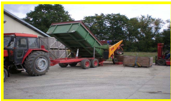
Fot. 3. Rozładunek przyczepy na kosz przyjęciowy, segregacja ziemniaków na dwie frakcje i napełnianie palet skrzyniowych na placu przed przechowalnią IHAR w Jadwisinie
