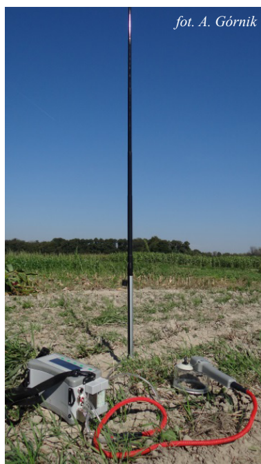
Ryc. 2. System SRS-1000 do pomiaru strumienia CO 2 pomiędzy glebą a atmosferą Fig. 2. System SRS-1000 for measuring CO 2 from the soil.
